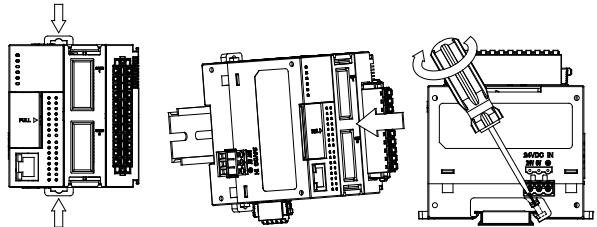
TR Modül üzerindeki iki DIN ray klipsini dışa doğru çekin. Altta modül oyuğunu DIN ray ile paralel konuma getiriniz ve sonra klik sesini duyana kadar klipsleri içe doğru bastırın.
