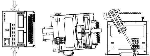
TR Modül üzerindeki iki DIN ray klipsini dışa doğru çekin. Altta modül oyuğunu DIN ray ile paralel konuma getiriniz ve sonra klik sesini duyana kadar klipsleri içe doğru bastırın.
